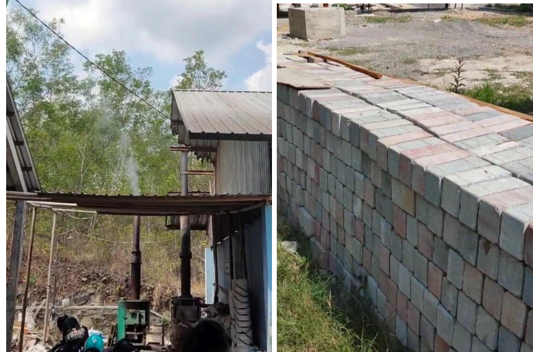
Gambar 3. Tungku Pembakaran dan Hasil Paving Block dari Sampah Popok
